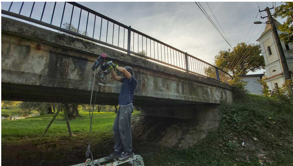
Obr. 38: Pohľad na odber vzoriek na nosnej konštrukcii mostného objektu
