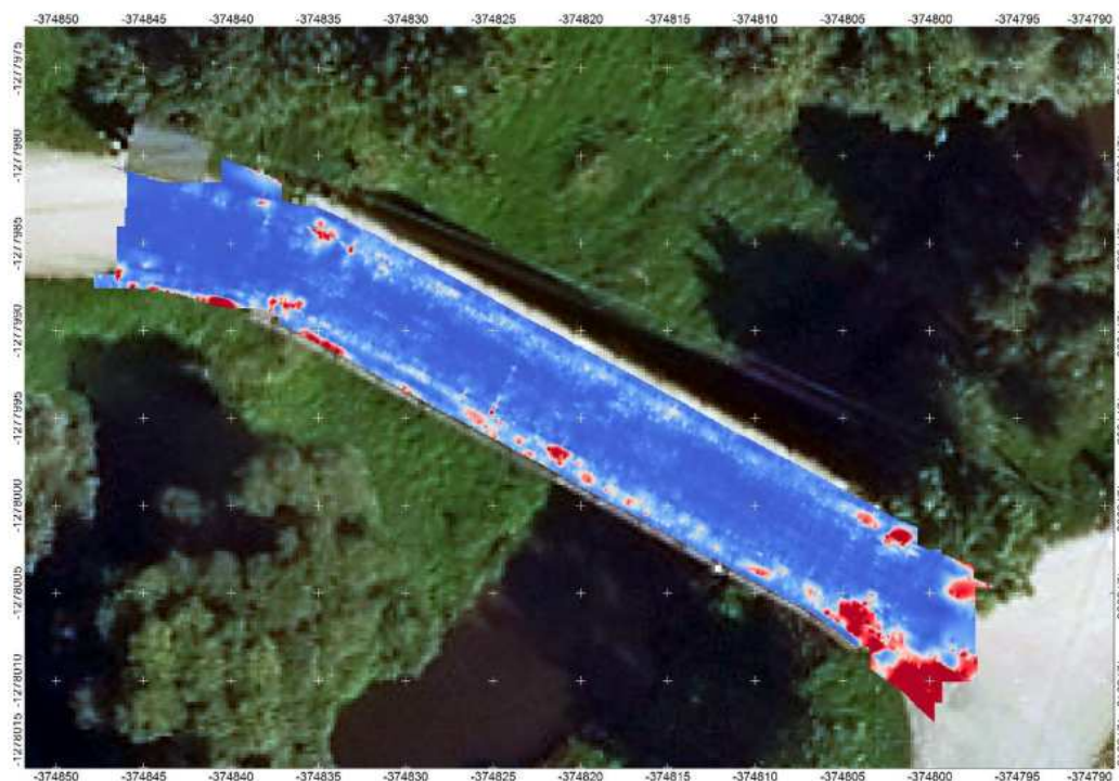
Obr. 88: Horizontálny rez 3D dátami pre hĺbkovú úroveň 181.29-181.34 m n. m. v JTSK
