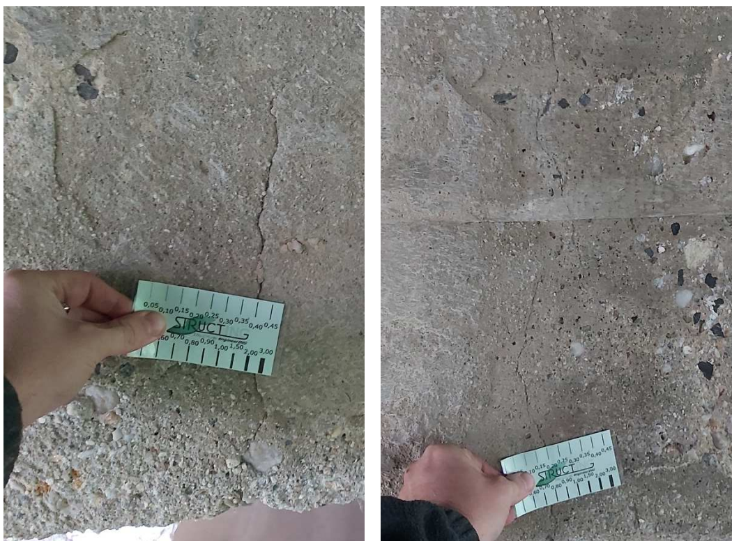
Obr. 28: Trhliny na povrchu úložného prahu
