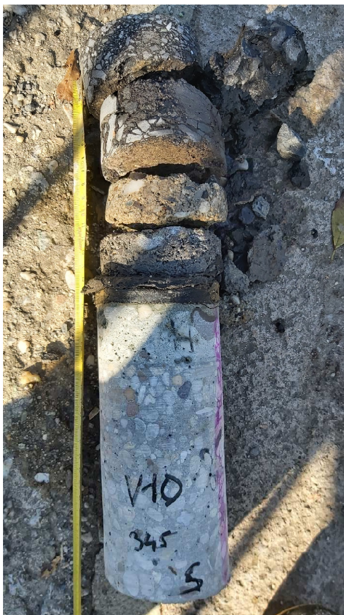
Obr. 82: Sonda pre zistenie skladby mostného zvršku – smer Boľkovce, v mieste zrejme pôvodnej skladby vozovky
