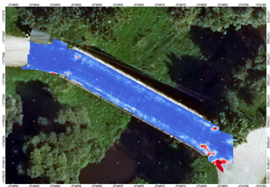
Obr. 92: Horizontálny rez 3D dátami pre hĺbkovú úroveň 181.24-181.29 m n.m. v JTSK – v mieste styčných škár medzi prefabrikátmi
