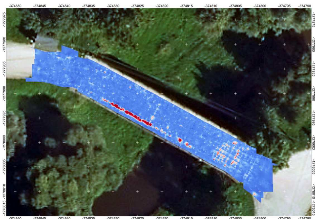
Obr. 94: Horizontálny rez 3D dátami pre hĺbkovú úroveň 180.54-180.59 m n.m. v JTSK – v mieste styčných škár medzi prefabrikátmi zhruba na spodnej hrane nosníka
