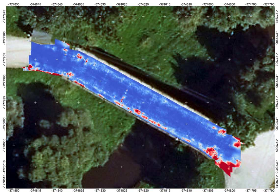
Obr. 91: Horizontálny rez 3D dátami pre hĺbkovú úroveň 181.34-181.39 m n.m. v JTSK – v mieste hornej pásnice prefabrikátov
