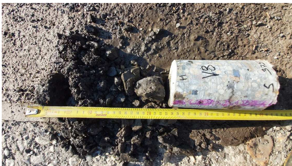
Obr. 43: Vzorky jadrových vrstov, zisťovanie karbonatizácie betónu
