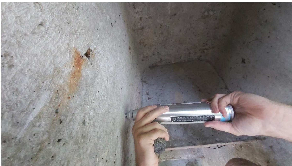
Obr. 37: Meranie odrazov pomocou Schmidtového tvrdomeru N
