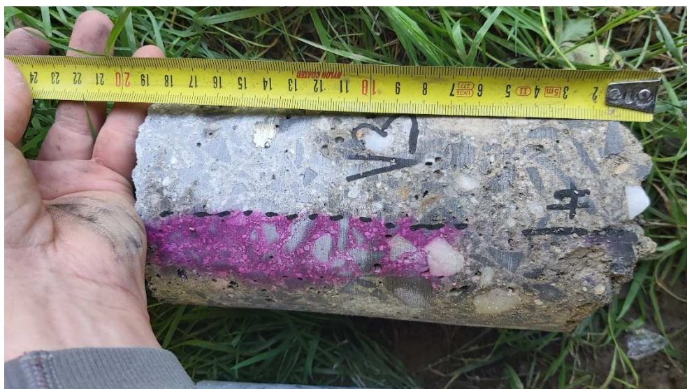
Obr. 42: Vzorky jadrových vrstov, zisťovanie karbonatizácie betónu
