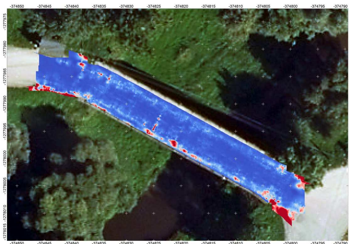
Obr. 90: Horizontálny rez 3D dátami pre hĺbkovú úroveň 181.39-181.44 m n.m. v JTSK
