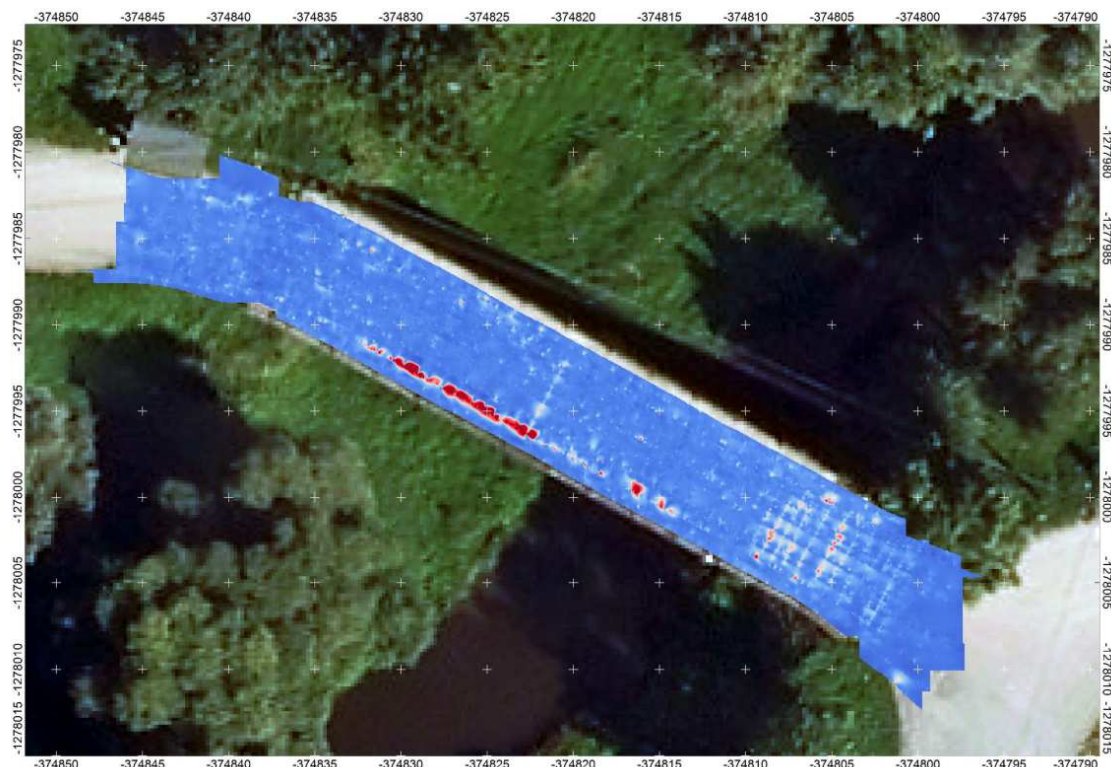
Obr. 93: Horizontálny rez 3D dátami pre hĺbkovú úroveň 180.69-180.74 m n.m. v JTSK
