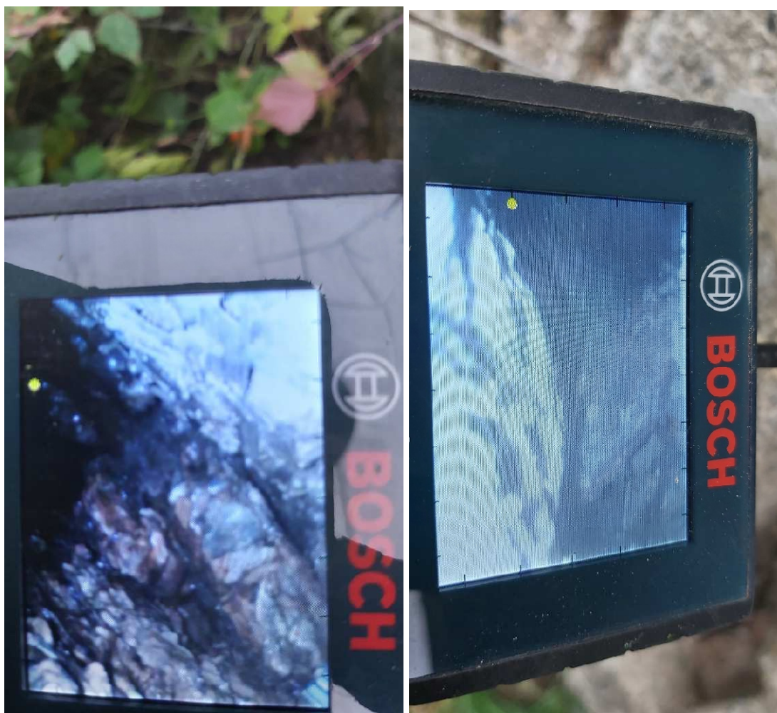
Obr. 79: Stav kotiev vnútri pri závernej stienke pri pohľade endoskopom (vpravo)
