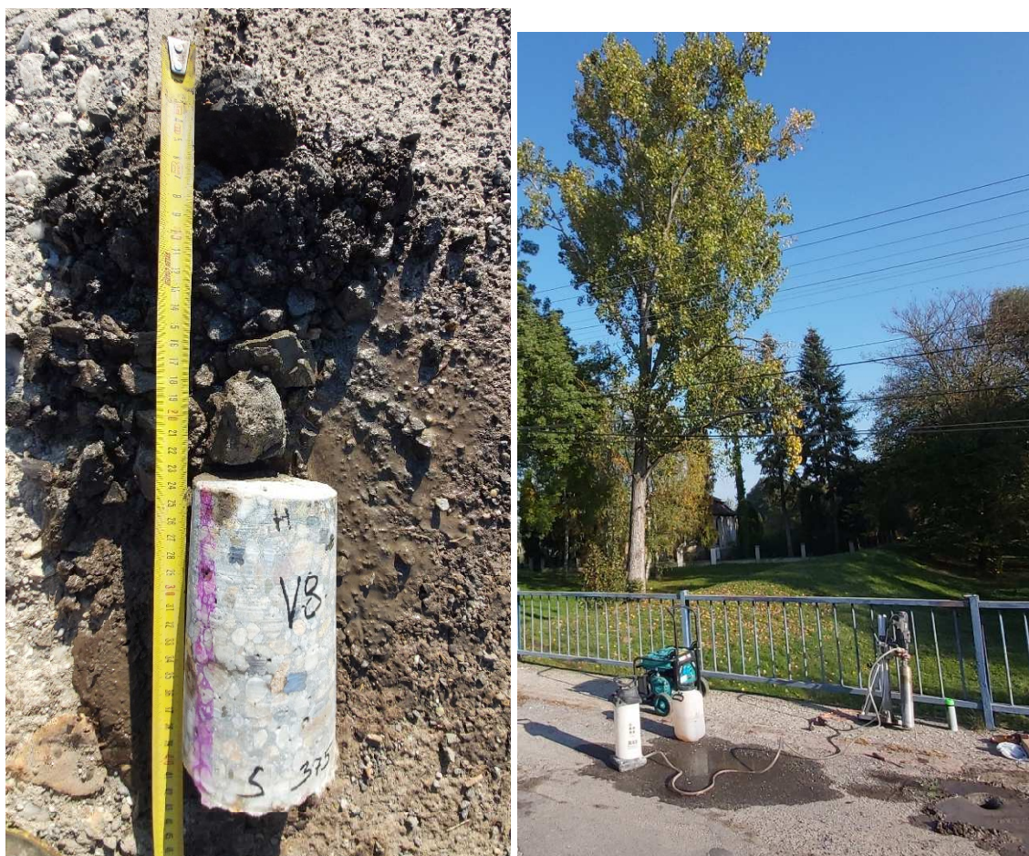
Obr. 81: Sonda pre zistenie skladby mostného zvršku – smer Holiša, v mieste opravovanej vrstvy vozovky
