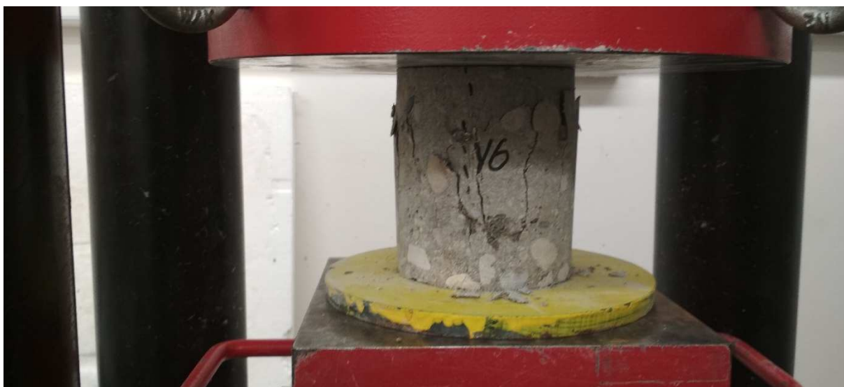
Obr. 40: Priebeh porušenia vzoriek
