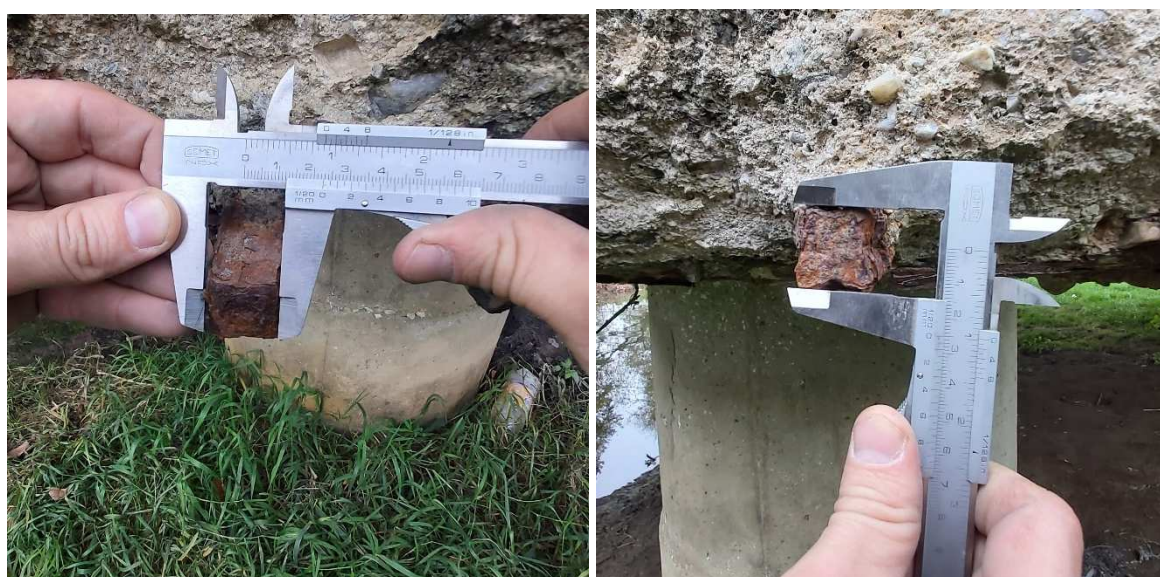
Obr. 47: Hlavná výstuž úložného prahu piliera 23,0 / 25,0 mm
